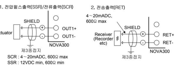
**CAUTION** 감전될 위험이 있으므로 제어출력 배선, 수신기(기록계 등), 조작단 설치 및 제거시에는 반드시 NOVA300 본체 전원 및 외부공급전원을 OFF하여 주십시오.
